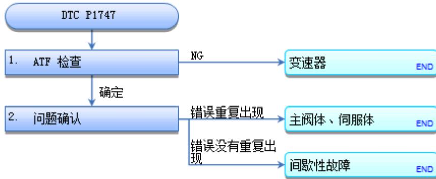
**DTC P1747:** 液压控制系统（切断 A 阀卡在 ON 位置或切断 B 阀卡在 OFF 位置）
